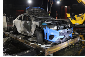
(d) External Damage for E-FM-S.
